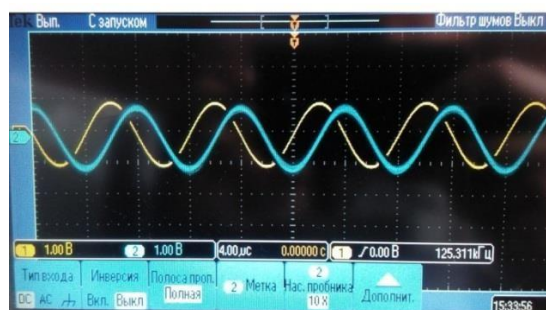
Рисунок 4 – Сравнение по фазе акустического сигнала и сигнала ЭДС индукции магнитоупругого эффекта (смещение на \frac{\pi}{2} ).
