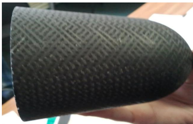
Рис. 2 Наконечник из углерод – углеродного материала
