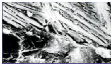
Рисунок 2 - Микрофотография структуры цементного камня: а) обычная структура цементного камня; б) фибриллярная структура цементного камня в модифицированной композиции.
