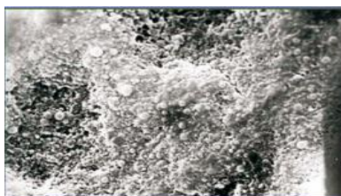
Рисунок 2 - Микрофотография структуры цементного камня: а) обычная структура цементного камня; б) фибриллярная структура цементного камня в модифицированной композиции.
