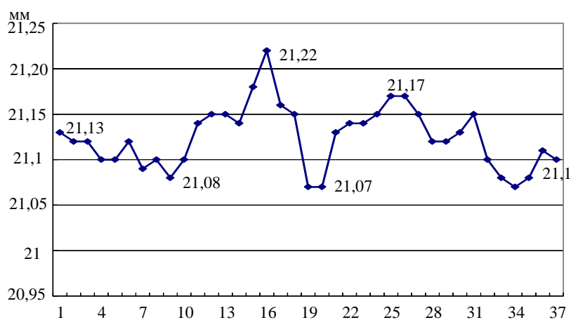
Рис.5. Экспериментальным путем измерения внутреннего диаметра трубы 21 мм.
