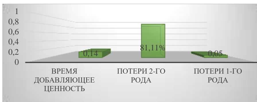
Рисунок 2 – Относительные показатели «потерь» и «времени», добавляющего ценность производимой продукции в общем времени процесса.
