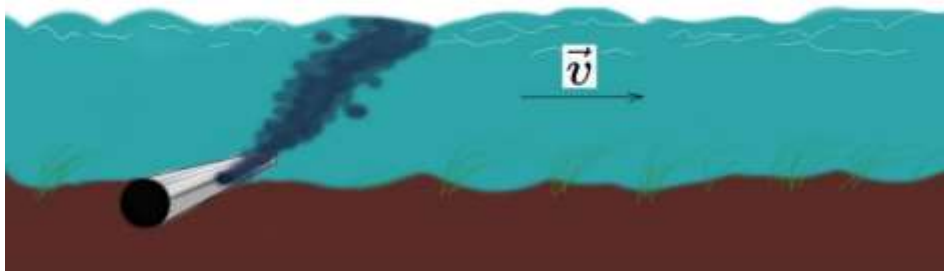
Рисунок 1 – Истечение нефти из трубопровода под водой
