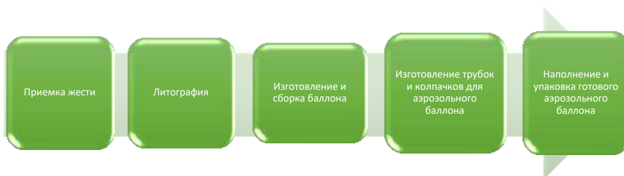
Рисунок 1 – Этапы процесса производства аэрозольной продукции
