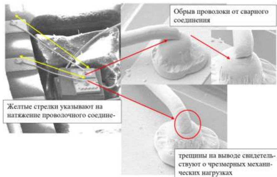
Рисунок 2 – Натяжение внутренних выводов, обрыв золотой проволоки от сварного соединения
