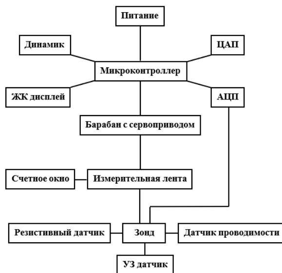
Рисунок 1 – Обобщенная структурная схема цифровой трехфункциональной контрольно-измерительной рулетки
