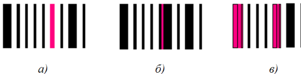
Рис. 4. Нечитаемый штрих-код после локальной усадки: а) локальная усадка штриха, б) локальная усадка пробела, в) локальная усадка групп штрихов и пробелов
