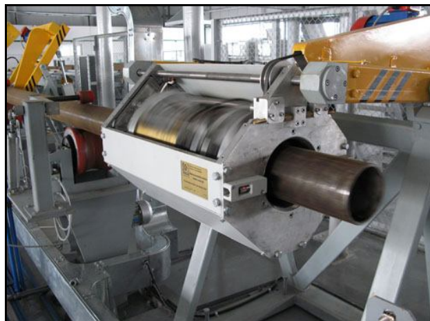
Рис. 3. Модуль ультразвукового контроля толщины стенки трубы
