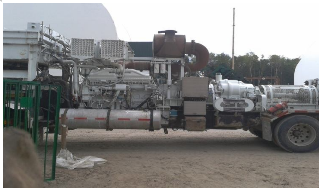
Рис.1. Насос, используемый для прокачки жидкости разрыва
