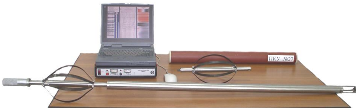
Рис. 1. Аппаратура МИД-ГАЗПРОМ К. В комплект входит: - скважинный прибор МИД-К; - Блок интерфейсный МИД-К ; - ноутбук «Compaq».
