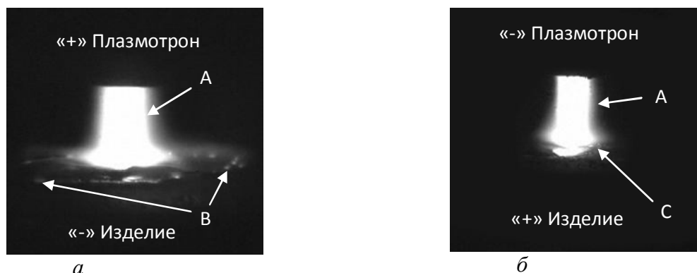
Рис. 1- Снимки процесса наплавки током обратной (а) и прямой (б) полярностей: А – столб плазмы; В – катодные пятна; С – область анодного пятна
