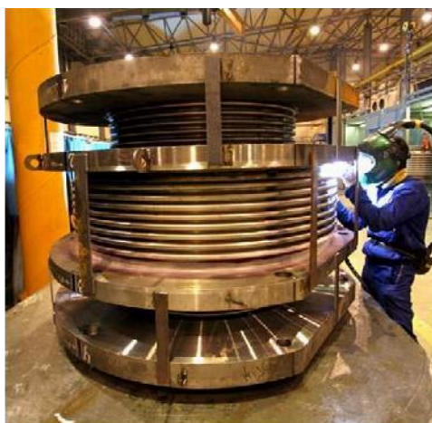
Рис. 1. Сильфонный компенсатор и его контроль
