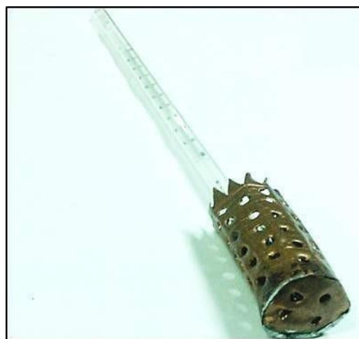
Рис. 3. Спиртовой термометр с перфорированным экраном
