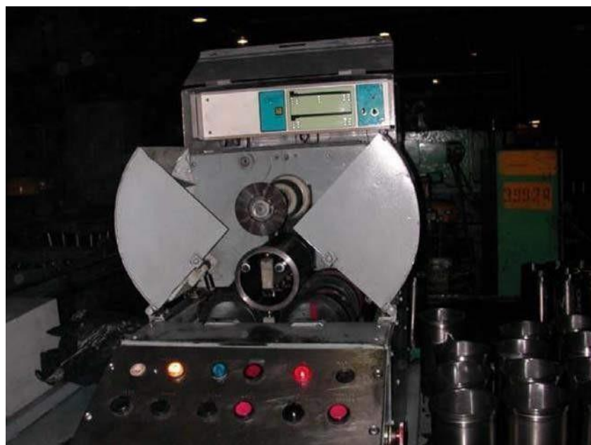
Рис. 1 Процесс дефектовки гильзы блока цилиндров дефектоскопом НТ-8
