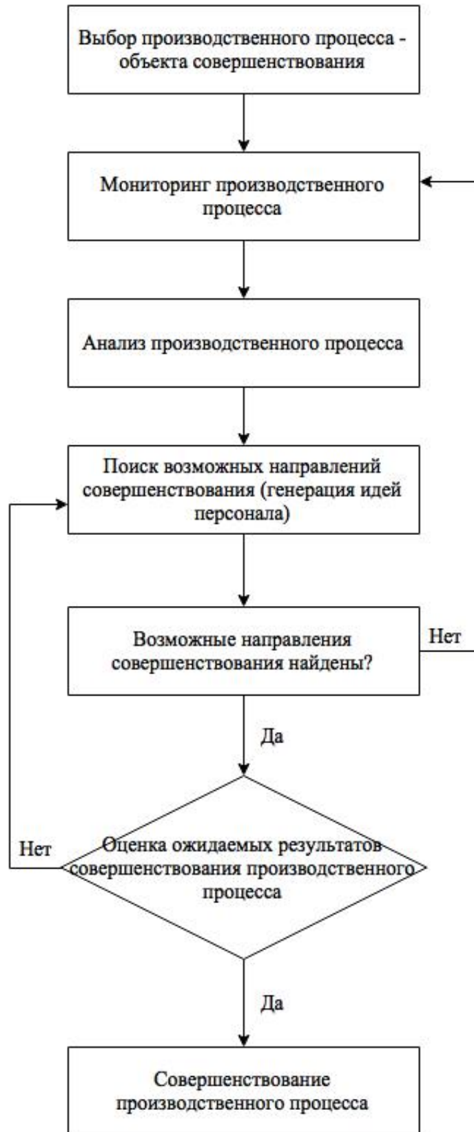
Рис. 1. Алгоритм совершенствования производственного процесса
