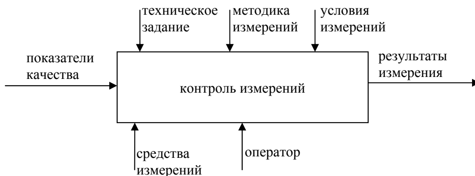
Рис. 1. Модель процесса «Контроль измерений»
