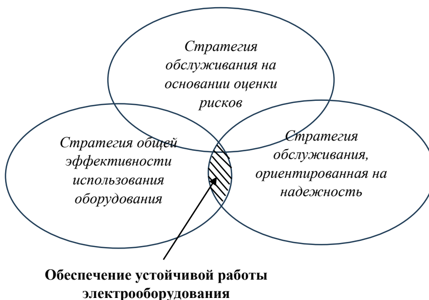
Рисунок 1 – Стратегии обеспечения устойчивой работы электрооборудования
