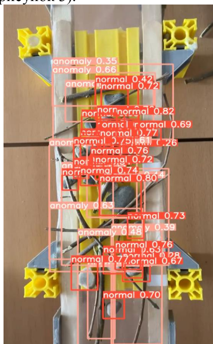
Рисунок 3 – Демонстрация применения YOLO на стенде конвейерной системы
