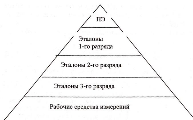
Рисунок 1 - Схема передачи размера от Первичного эталона (ПЭ) рабочим средствам измерений
