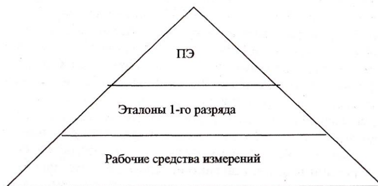
Рисунок 2 - Новая схема передачи размера от Первичного эталона (ПЭ) рабочим средствам измерений
