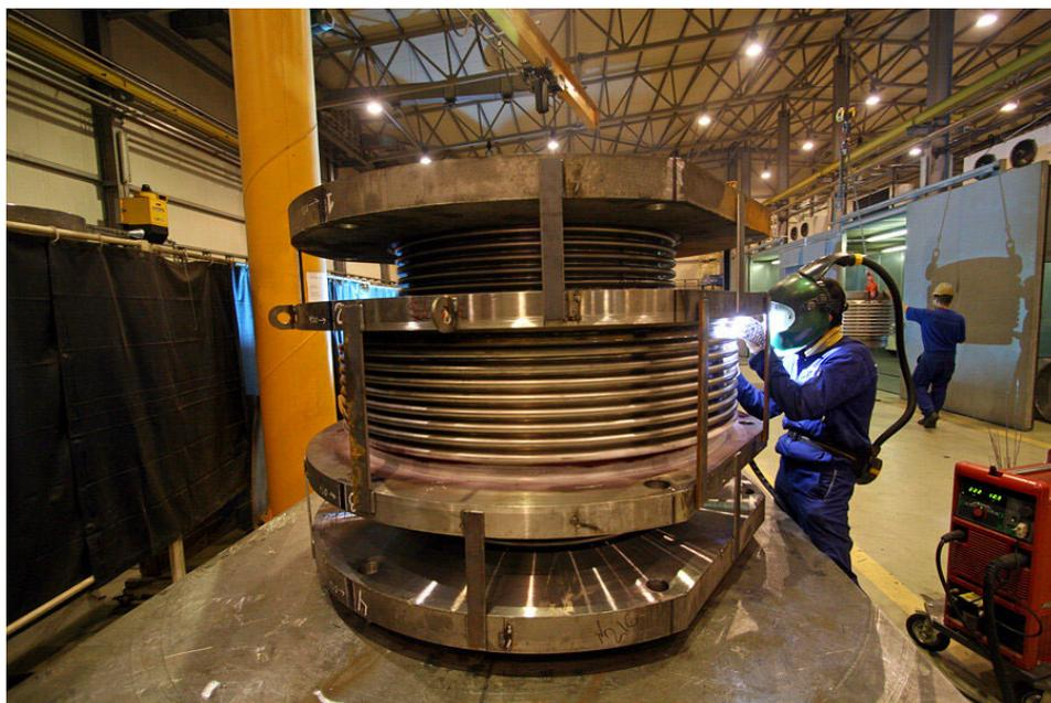
Рисунок 1. Сильфонный компенсатор и его контроль
